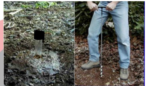
Barreno y correcta instalación de tubo
